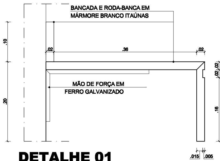
DETALHE 01 BANCADA E RODA-BANCA ESC.: 1/5
